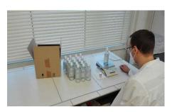
Anhand von Stichproben und unter Verwendung präziser Messgeräte sowie entsprechender Prüfsoftware wird geprüft, ob die durchschnittliche Füllmenge (Mittelwert) einer Stichprobe der angegebenen Nennfüllmenge entspricht und die von der Nennfüllmenge abhängigen zulässigen Toleranzen (zulässige Minusabweichung, Wert der Verkehrsfähigkeit) eingehalten werden (§ 9 FPackV).
